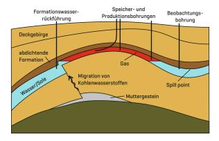
Während es das Ziel bei der Öl- und Gasgewinnung ist, die förderbaren Reserven möglichst genau abzuschätzen und eine maximale Förderung zu erreichen, steht bei der Erdgasspeicherung die optimale Nutzung der Kapazitäten im Fokus. Die ursprünglich für Erdöl- und Erdgaslagerstätten entwickelten Verfahren können auch für die Konzipierung von Untergrundspeichern in ausgeförderten Lagerstätten und in Aquiferformationen (wasserführende Schichten) genutzt werden.
